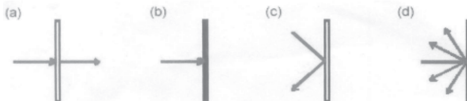
Fig 1: Sound/Surface Interaction: (a) transmission, (b) absorption, (c) reflection, (d) diffusion
